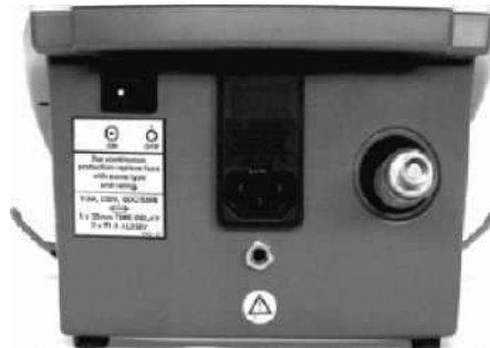
Rycina 3.1 — Ściana tylna urządzenia — wyłącznik zasilania , gniazdo dla kabla zasilającego, złącze dla terapii kombinowanej i uchwyty dla aplikatora 1 cm 2
