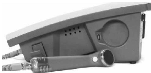
Rycina 3.3 — Widok z boku — Uchwyt dla aplikatora z ruchomym magnesem i haczykiem
