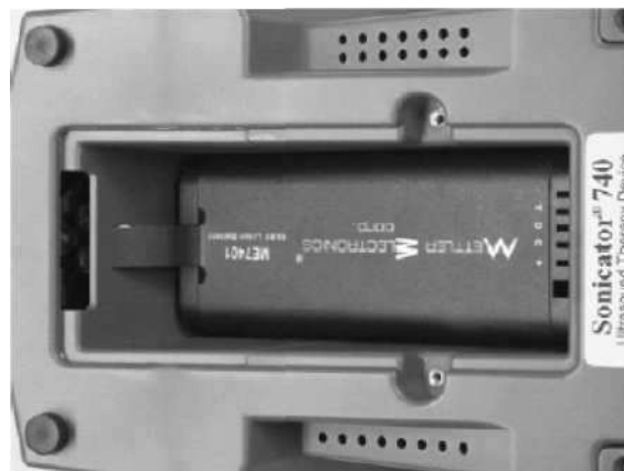
Rycina 3.5 —Instalacja baterii
